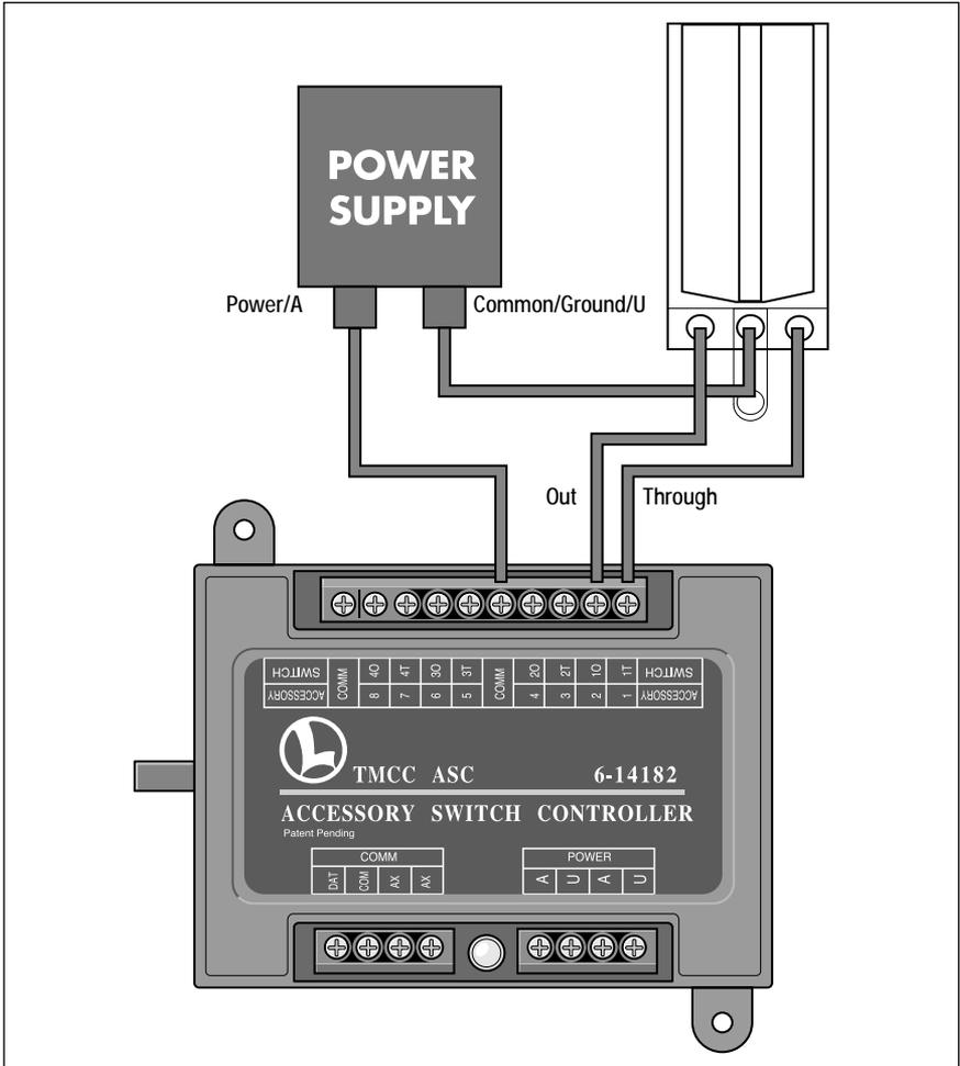
Figure 16. Atlas Switch wiring
